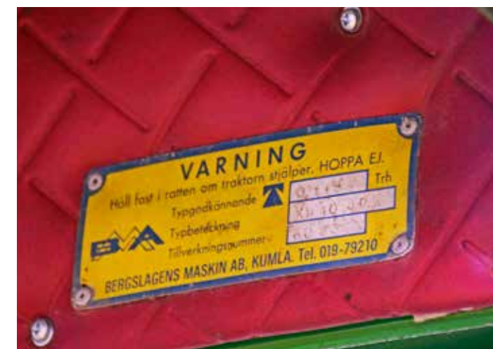
Hytten är byggd i Sverige hos Bergslagens Maskin AB i Kumla. Typskylten uppmanar om att man ska hålla sig kvar i hytten om traktorn stjälp.
