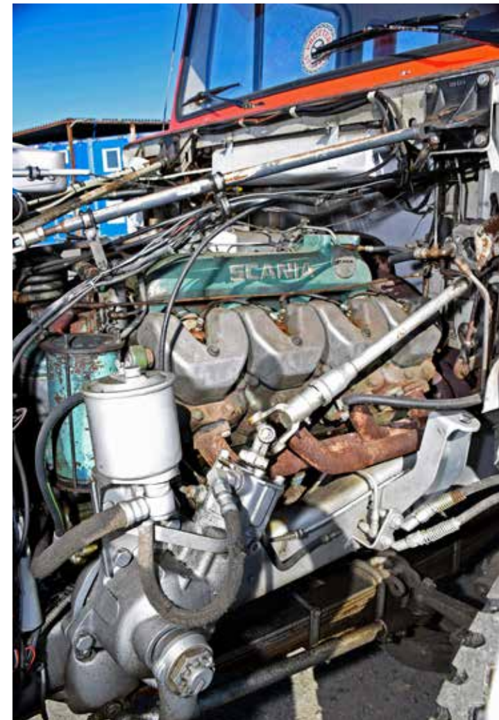
DS14-motorn med de karaktäristiska v-formade ventilåpningarna som fått stå som modell till den moderna V8-logon hos Scania.
