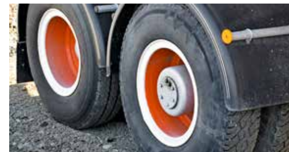
Bakaxeln med navreduktion var lösningen inom de tyngre och tuffare transporterna. Med detta undveks många avdragna drivaxlar.
