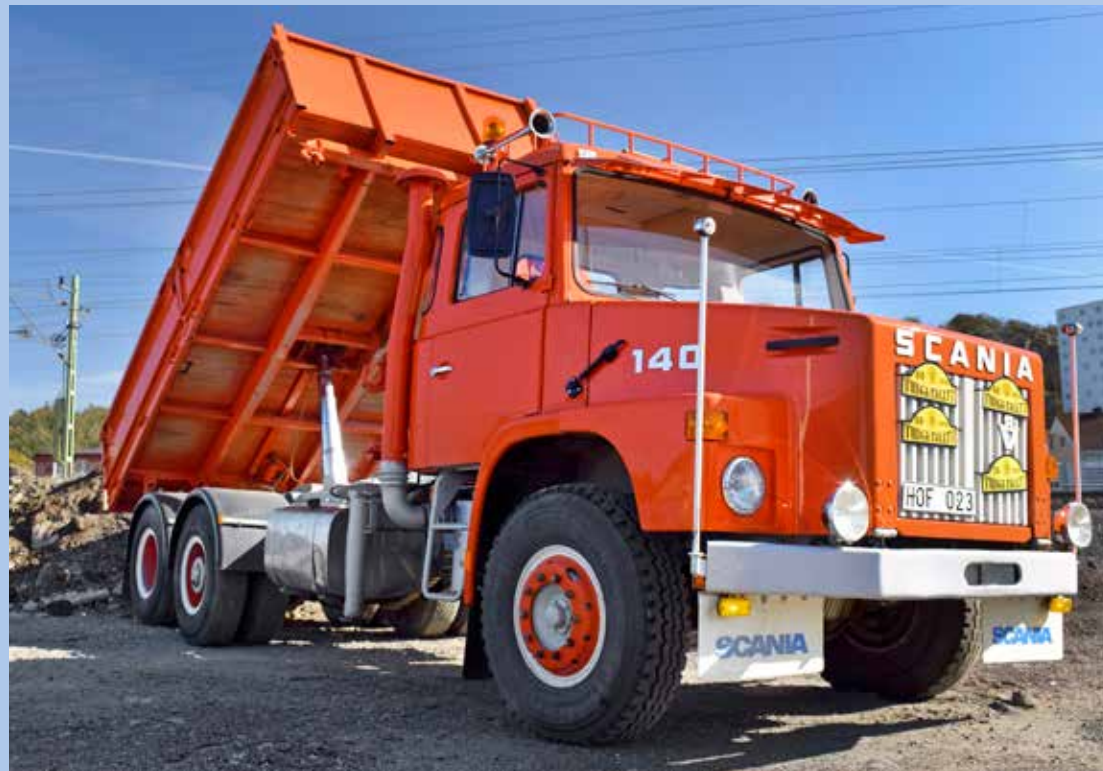
Zetterbergs trevägstipp från Östervåla kom på bilen en bit in på 2000-talet. Dessförinnan har den haft ytterligare två tippflak på ramen.
