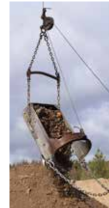
Bild: Kollandas 38 RB_004: (a eller b) Släpskoppan är idealisk för bland annat avskalning av ytlager i torvmosse, muddringsarbeten eller som i detta fall, hämta grus under vattnet.
