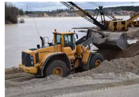
Bild: Kollandas 38 RB_014: (Kan strykas) Även moderna maskiner finns så klart hos Kollanda Grus AB. Ett exempel är denna Volvo L220 hjul-lastare bär undan ur högen efter slängskoppan.
