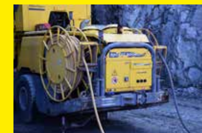
Bohus Borr_005: Vindan på vänstersidan är för elkabeln till eldriften. På högersidan sitter vindan för vattenslangen som förser borrhöggen med kylvatten.
