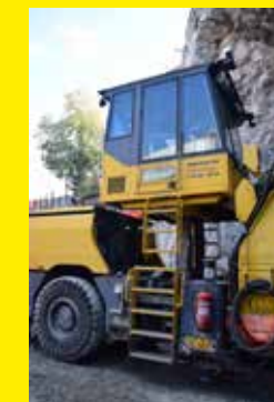
Bohus Borr_006: Hytten tillverkad av AB Allt i Plåt i Åseda är rymlig med en innervolym på åtta kubik. Det behövs då två maskinister sköter riggen samtidigt.
