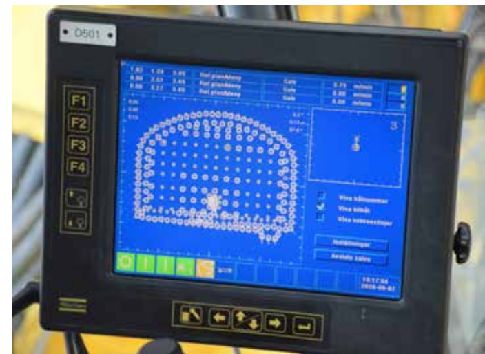
De tre bormaskinerna styrs med joystick från två stationer i hytten. På skärmen visas borrhåtan med varje borrhål och i vilken vinkel det ska borrar.
