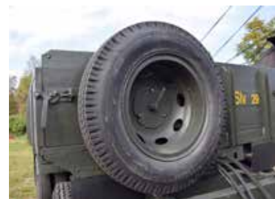
Reservhjulet sitter på släpvagnens framstam. Inga breddäck här inte, 7.50-20 var dimensionen som gällde i detta fall.
