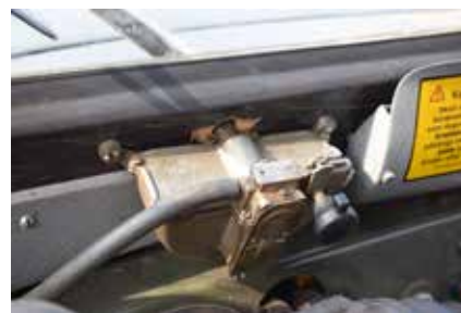
Trico har varit i branschen sedan 1917. Deras vakuumporkare sitter milt beskrivet lättåtkomligt mellan framrutan och instrumentbrådan.
