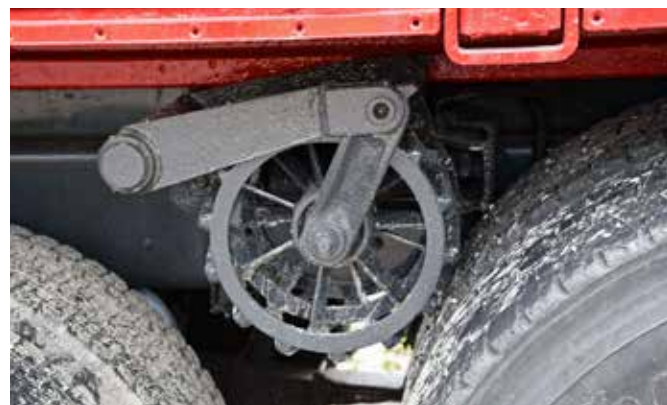
Axelkonfigurationen 6x2 och Zetterbergs Robsondrive var det som fortfarande gällde i anläggningssvängen.
