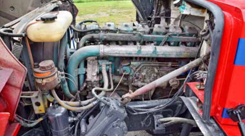
9-litersmotorn med sina 280 hk blev med tiden i underkant inom anläggnings-transporter. Men det fanns även motorsvagare versioner på 230 och 250 hk.
