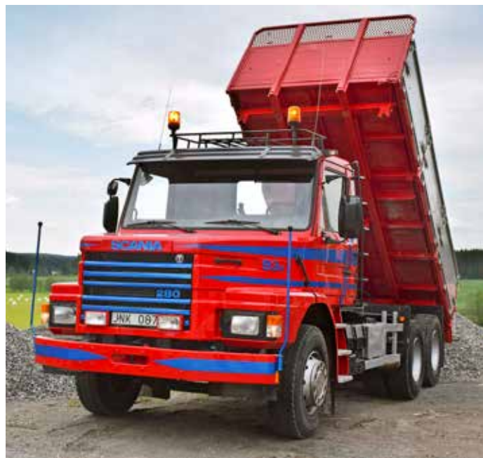
Motorhuv, boggi med drivning på en axel, 4,20 axelavstånd och trevägstipp. Ett klassiskt recept inom bygg- och anläggningstransporter även i slutet av 80-talet.
