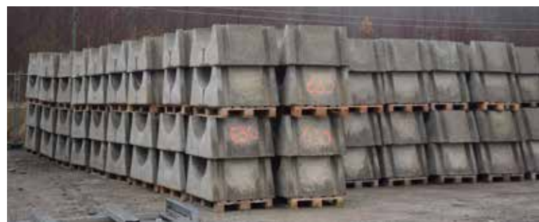
GEM2 belastningsvikterna är av betong och fästs undertill på PE-rören med spännband av polyesterfiber. Det behövs för att de inte ska flyta upp till ytan. De vikterna som är till 400-rören väger cirka 430 kilo styck.
