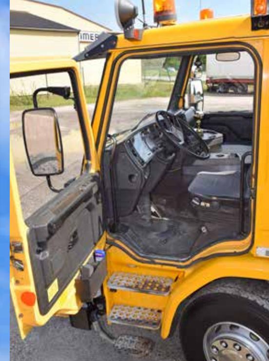
Förarmiljön i Scanias 3-serie med ljus interiör och svängd instrumentbräda låg i framkant när den kom i slutet av 80-talet. Den lågt placerade hytten där P sägs ha stått för "Pretty" när den togs fram vilket bland annat betyder nätt, näpen och söt, något som nog många vill skriva under på.
