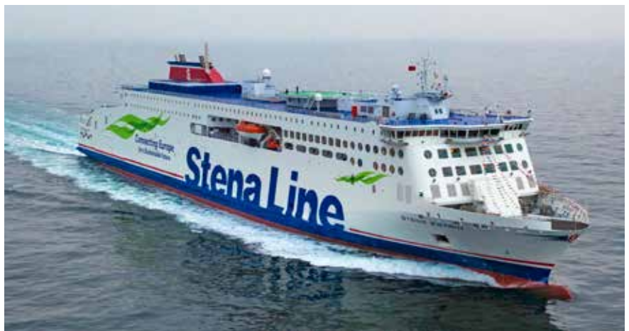
Det under 2019 levererade Stena Estrid var det första i den senaste fartygsserien E-Flexer. RoPax-fartygen på 7 770 DWT tar 927 passagerare.
