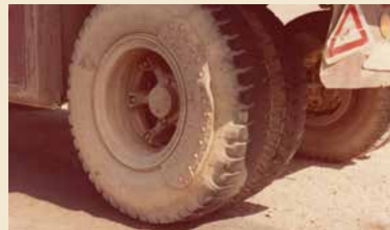
Så här lagades däck i arabländerna. Ett sämre däck fick släppa till en bit som bultades fast över däckskadan. Även många andra reparationer utfördes längs vägarna.
