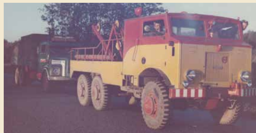
Kardanaxeln gick av vid Hova på Valle Vikströms Scania-Vabis LS76. En mäktig Volvo TVC bärgare kommer väl tillhands i sådana lägen.
