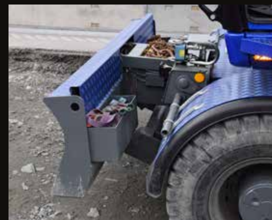
Det parallellförda schaktbladet är specialbyggt av Näs Motor & Maskin. Förvaringslådor för stroppar och kättingar finns fram och bak.
