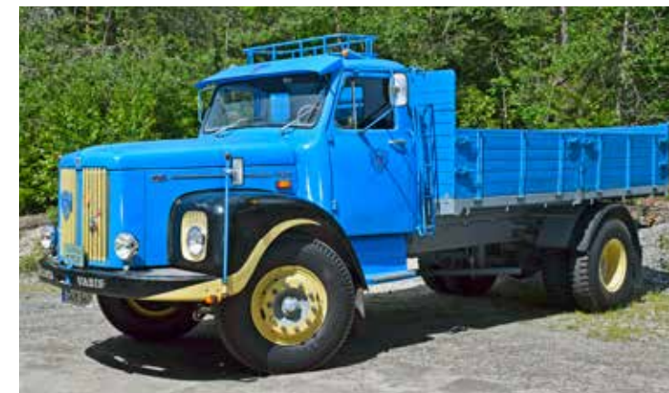
L66 var egentligen en hybrid främst för exportmarknaderna. 76:ans chassi med frontpartiet och under huven 56:ans motor. 1968 ersattes modellen av L85.
