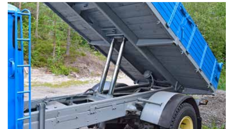
Dubbla hydraulkolvar, hydraultank med inbyggd pump och luftklocka till spridarlämnan visar sig när flaket tippas.
