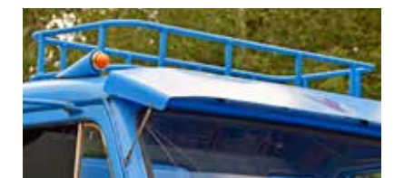
När man inte hittar färdigt, ja då får man bygga själv. Uno har smitt ihop korgen och positionsljusen på taket.
