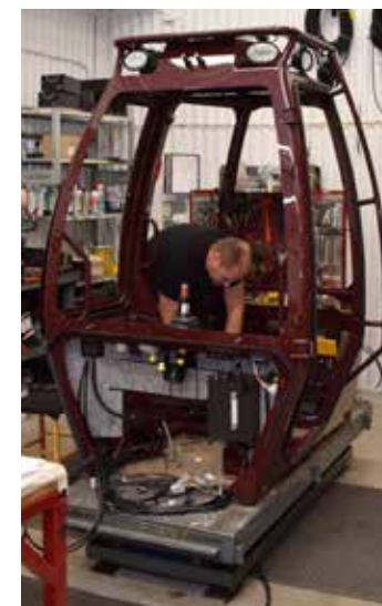
Hytterna byggs av Weland i Smålandsstenar efter Alstors design. David Haglund kompletterar med bland annat eldragningen till utrustningen.
