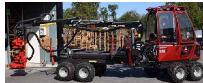
Alstom 840 PRO som kombimaskin med Tapio 160 skördaraggregat. Vid leverans tas de bakre bankarna bort.
