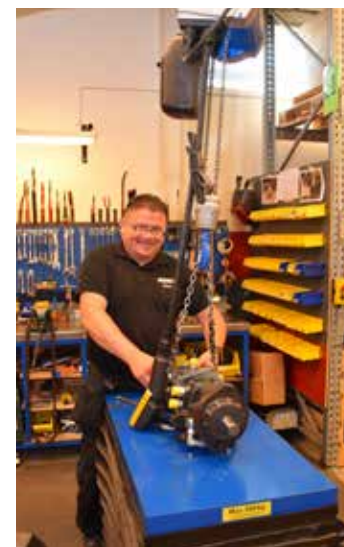
Johan Björbeck monterar ihop transmissionshusen på sin arbetsstation. Både lyftbord och travers behövs då komponenterna är tunga.
