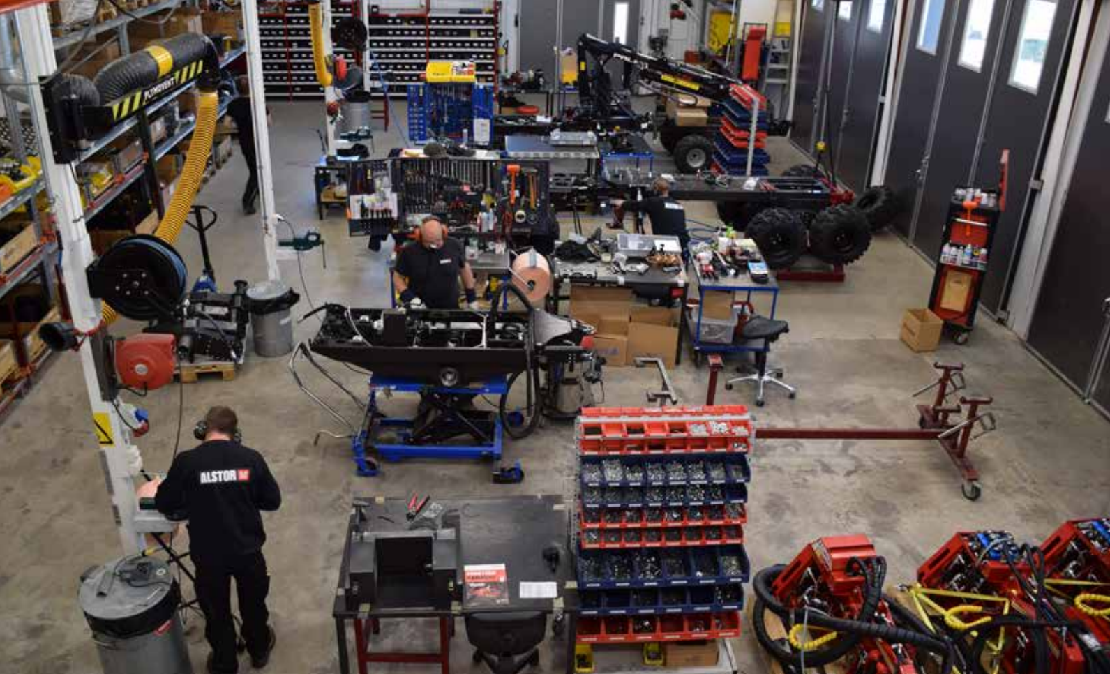
Varje maskin byggs hantverksmässigt på var sin station. Löpandebandsprincipen har frångåtts. Överallt är det snyggt och prydligt.
