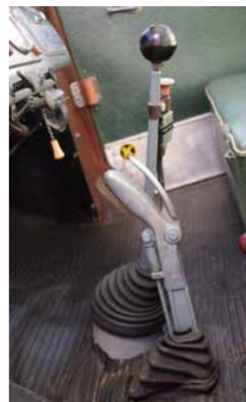
Kort stump till parkeringsbromsspak och växelspaken går raka spåret upp ur golvet. Norrlandsväxel dubblerade antalet växlar.
