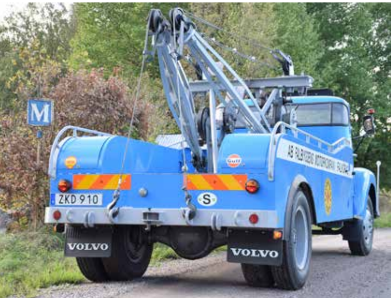
Bärgningsaggregatet tillverkade Tranåsverken på licens från Holmes i USA. Så mycket draget har det inte blivit på senare tid, men det fungerar.
