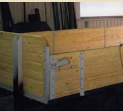
Flaket byggdes upp från grunden då originalflaket var utom räckvidd efter alla år av laster, väder och vind. (Foto: Thomas Hansson)
