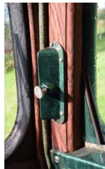
Floby-hyttens egen lösning med ventilationslucka i dörrstommen framför sidorutan fungerade också.
