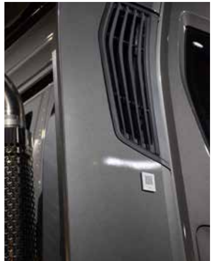
Scania återinför högt placerat luftintag som kommer i två utföranden.
