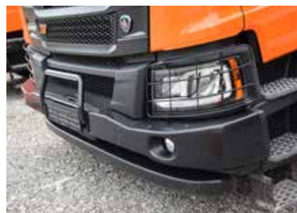
Extra kraftig och högt monterad stötfångare och rejäl dragbult kännetecknar XT.
