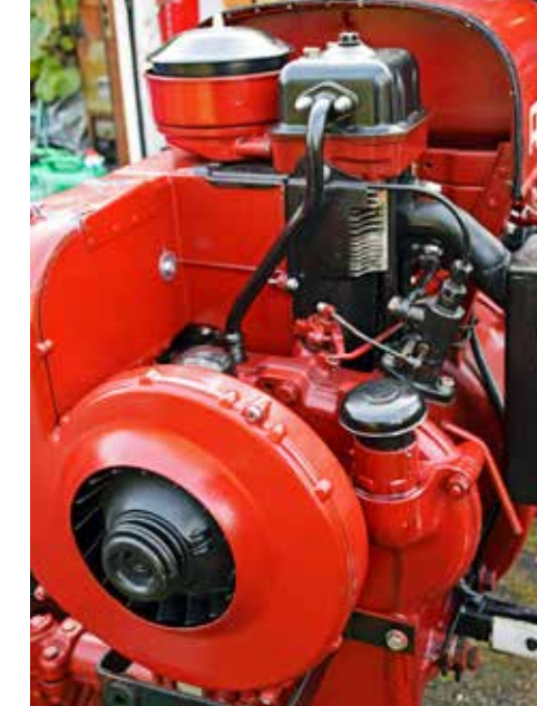
Den encylindriga luftkylda dieselmotorn på 822 kubik gav 12 hästkrafter. Porsche-designen med separata cylindrar fanns även i två-, tre- och fyrcylindriga varianter.
