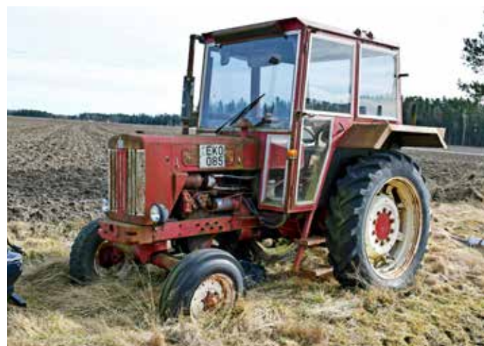
Mats Torstenssons IH McCormick B-614 från 1965 med välglasad hytt står mest still på grund av sina egenheter. Hydrostatisk styrning har den i alla fall fått en gång i tiden.
