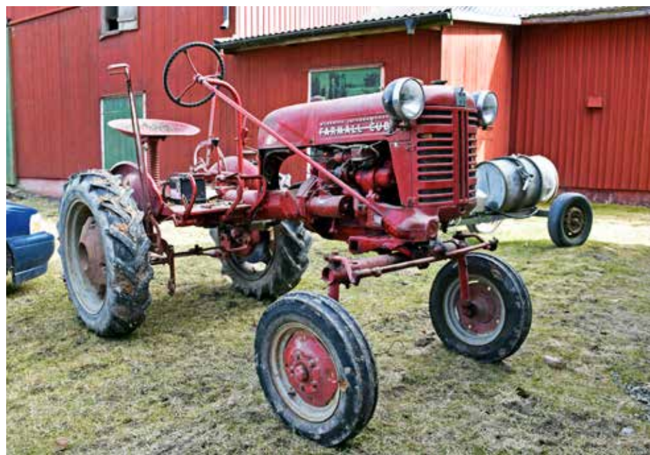
IH McCormick Farmall Cub tillverkades i USA 1947 till 1958. Torstenssons är från 1955. Motorn är en 12-hästare med självcirkulerande vattenkyllning.
