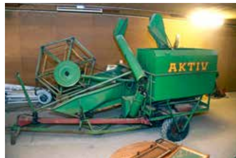
En Aktiv M bogserad tröska med fem fots skärbord finns också sparad. Modellen tillverkades i stor upplaga av AB Westeråsmaskiner från 1948 till 1969.
