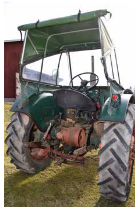
Bore Lyx-hytten var ingen säkerhetshytt utan bara ett väderskydd. Taket kunde fällas ner som en sufflett. Och om det inte räckte kunde överdelen lyftas av.
