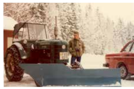
Till Teddyn köptes en ordentlig snöplog. Den satt monterad på framaxeln och genom en vajer bak till hydraulen kunde bladet höjas och sänkas.
