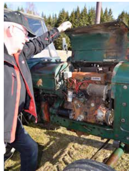
Austinmotorn satt även i personbilen Austin A70 där den gav 67 hk. I traktorversionen med sänkt kompression räckte det med 29 hk.
