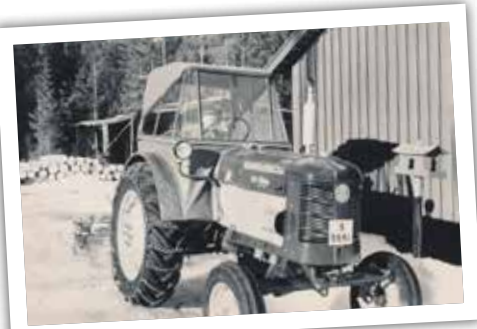
Notera den egentillverkade motorplåten. En sådan på varje sida gjorde att värmen från motorn mycket effektivt leddes in i hytten.
