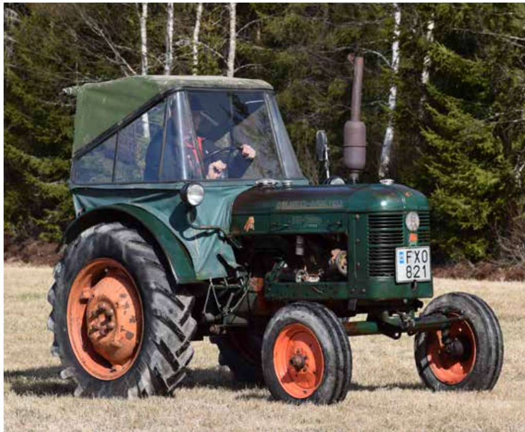
Bore Lyx-hytten var ingen säkerhetshytt utan bara ett väderskydd. Taket kunde fällas ner som en sufflett. Och om det inte räckte kunde överdelen lyftas av.
