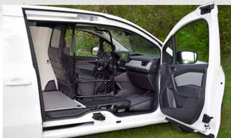
Easy Side Access heter lösningen utan B-stolpe som ger en öppning på 1.466 mm. Hopfällbart säte och vridbar skiljevägg ger möjlighet till extra lång last.
