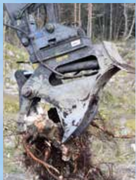
En kraftfull Pallari KHM-125 stubbklipp tillsammans med en Encon EC226 tiltrotator ser till att stubbarna dras upp och klipps ner i behändigare bitar.
