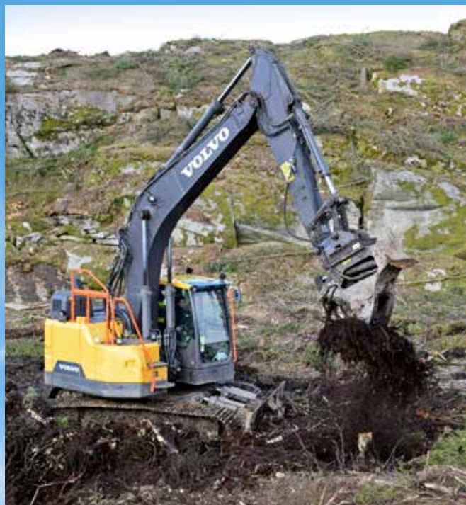
En kraftfull Pallari KHM-125 stubbklipp tillsammans med en Encon EC226 tiltrotator ser till att stubbarna dras upp och klipps ner i behändigare bitar.
