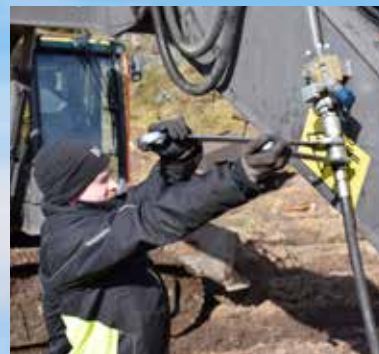
En kraftfull Pallari KHM-125 stubbklipp tillsammans med en Encon EC226 tiltrotator ser till att stubbarna dras upp och klipps ner i behändigare bitar.
