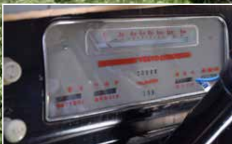
LV112:an har ett elegant instrument med mätare för hastighet, laddning, tankvolym, kilometer, oljetryck och temperatur.
