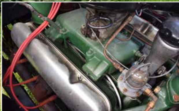
Under motorhuven på LV112:an är det inte riktigt original. Där sitter en Volvo B36 bensin-V8. Men originalmotorn finns iordninggjord.
