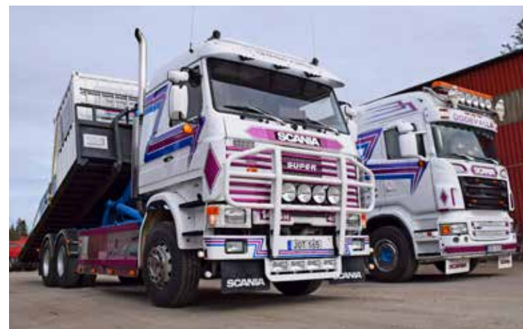
Åkeriets V8 är en Scania R143H 450 Topline krokväxlare från 1996. Den renoverade Peter och Melinda tillsammans och byggde om från en 6x4 till en 6x2.
