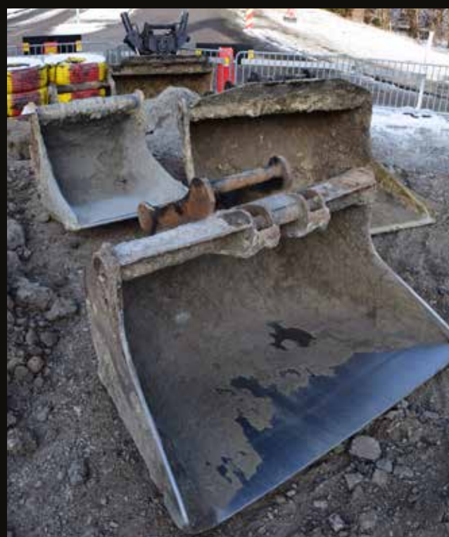
Till maskinen hör ett brett urval skopor och tillbehör. Djupskopa, släntskopa, VA-skopa och två olika planerigsskopor tillsammans med tjälkrok, gafflar och rörläggare.
