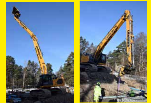
Lerbergs_003: (a eller b) Lerbergs maskin är den första i landet ur Generation 8 med 16,5 m Multi User-aggregat. Det konstruerades av Liebherr Sverige för den svenska marknaden.
