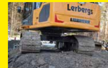
Lerbergs_004: Bandvagnen är en LC-V bandvagn med 900 mm plattor i HD-utförande. De förstärkta plattorna utlovas hålla 10.000 timmar längre än standardplattorna.
