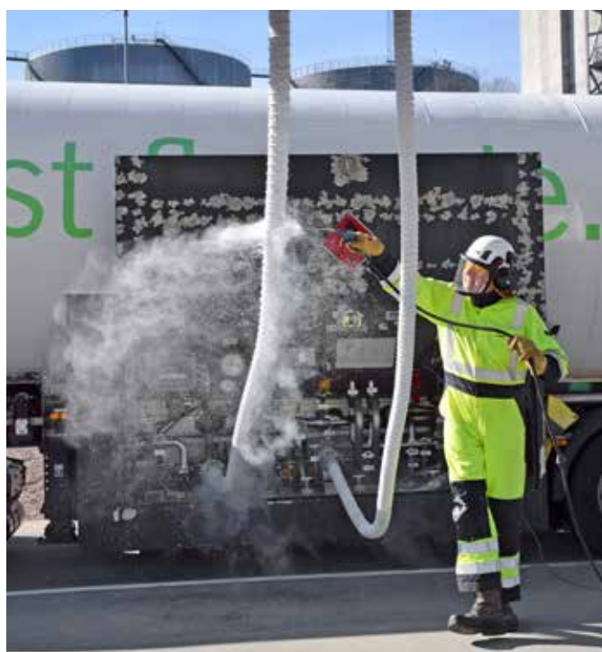
Efter lastning och lossning behöver slangarna kokas av så att gasen kan dunsta bort. Genom att blåsa rent slangarna från iskristaller värms de upp snabbare.
