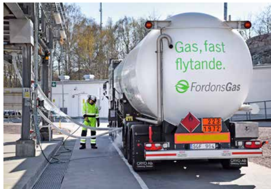
Cryo AB i Göteborg levererade gastanktrailern 2011. 52,5 kubik rymmer den välisolerade tanken och trailern väger strax över 14 ton utan last.
