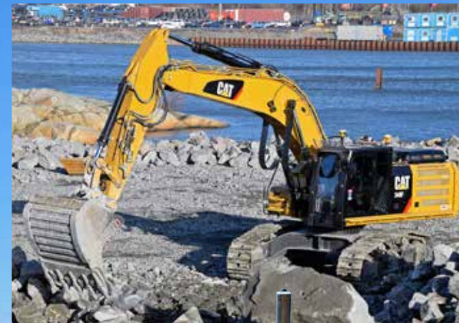
Den senaste grävmaskinen som nyligen tagits i bruk av Bohus Bergsprängning är deras Caterpillar 40-tonnare 340F.
