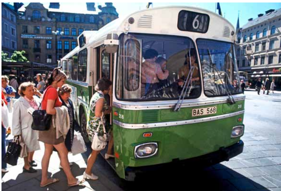
En instegshöjd på 64 cm var efter dåtidens mått mätt extremt lågt vilket syns på detta exemplar CR76 på Stora Torget i Uppsala. 80 passagerare varav 32 sittande svalde den. Foto: Scania.
