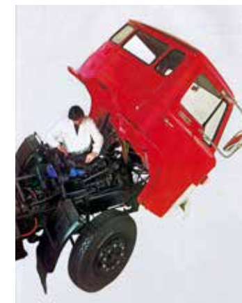
För att underlätta serviceingrepp hade D-serien tipphytt och motorerna lutade i 45 grader. Lutningen gjorde också att hyttgolvet kunde byggas lägre.
