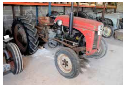
Till synes en vanlig, men rödmålad TEF-20 diesel från 1955. Men det speciella är att den har reduktionsväxel som gav åtta körväxlar och två backväxlar.
