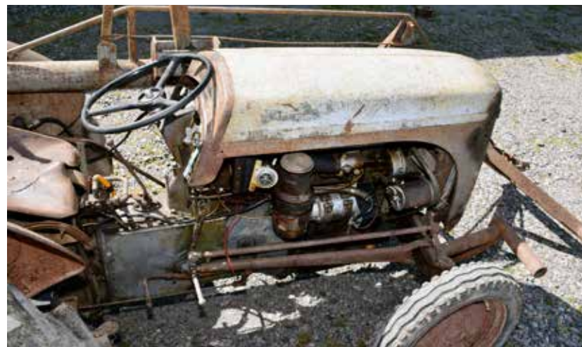
En P3-konverterad Grålle finns också hos Thomas. Den större Perkinsmotorn krävde motorhuvens höjdes och en distansplåt fick sättas över instrumentbrädan.
