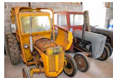
Då denna gick på en trång bräddgård i Göteborgs skärgård var det säkrast att ha en extra kraftig bäge. Notera lösningen med sidoöppning av motorhuven.
