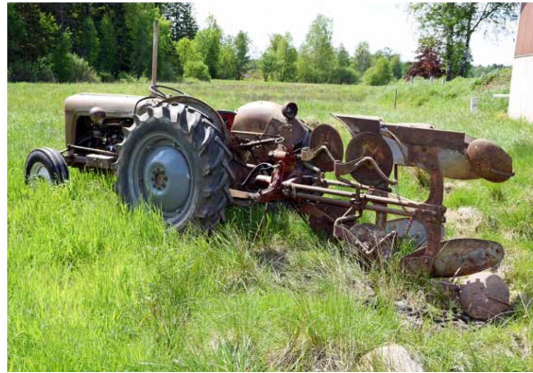
En Fergusons 2-skäriga växelplog 797. Skylten kvar som berättar att detta är ett demonstrationsexemplar från AB Farming sitter kvar.
