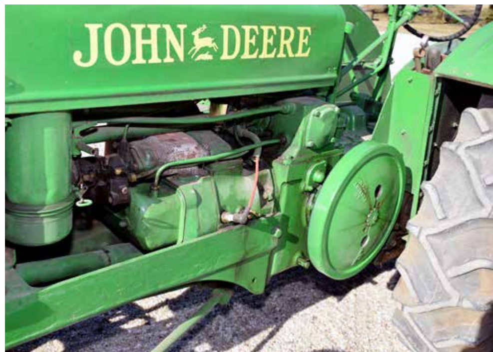
Modell BR innebär ett lite annorlunda motorkoncept med liggande 2-cylindrig bensin/fotogenmotor. Lösningen innebar kompakta mått och färre delar.
