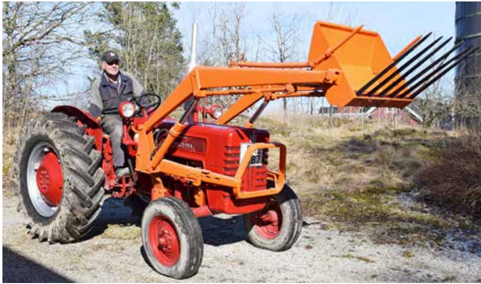
Bertil har på sin IH McCormick B-275 från 1964 en Källve 600 frontlastare. Den sitter med snabbkoppling så den kan lätt ställas av.
