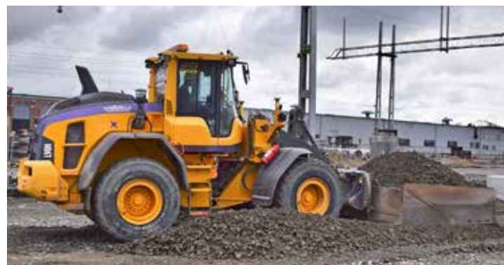
Rickard Nilsson kör Stråvallas L90H hjullastare från 2017. Med planerings-skopan konverterad med extra gavlur trycks materialet effektivt ut.
