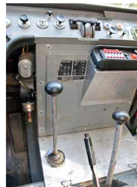
Den förstärkta Volvo M40-lådan sköts med en spak och ZF fördelningslådan med den andra. Spaken på "torpedväggen" är släpvagnsbromsen.
