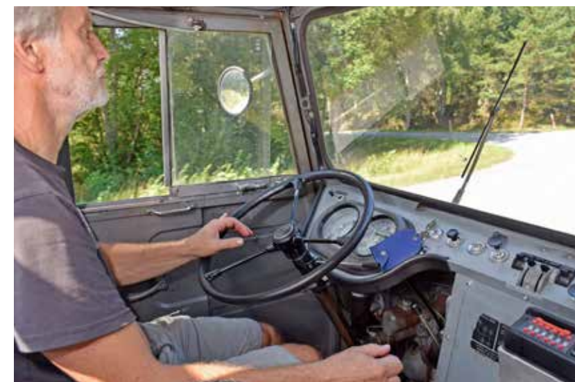
Den förstärkta Volvo M40-lådan sköts med en spak och ZF fördelningslådan med den andra. Spaken på "torpedväggen" är släpvagnsbromsen.
