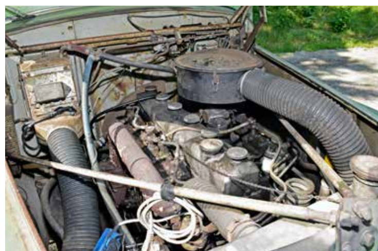
Scanias D8-motor med en cylindervolym på närmare 8 liter ger 140 hk. Med bra lass på flaket märks det tydligt att det inte är turbo.
