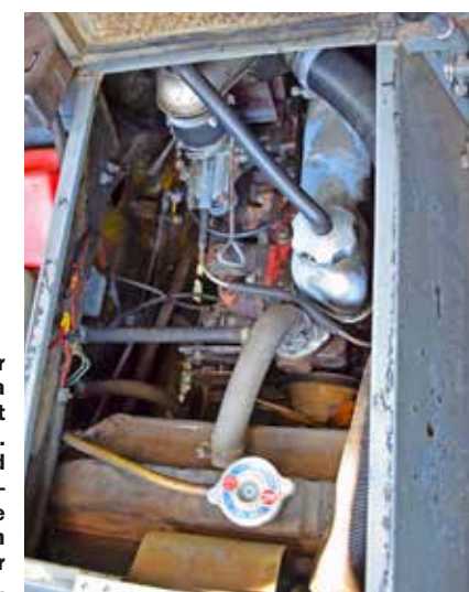
1968 var egentligen sista tillverkningsåret för B18-motorn. Men B18 A med enkel Zenith-förgasare gällde för L3314 fram till den togs ur produktion 1970.
