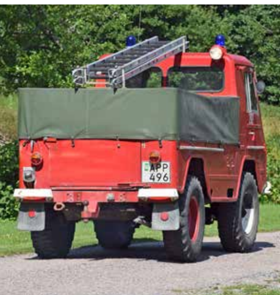
Fylla på bensen gör man längst bak på Valpen. Där bak finns också en 80 mm dragkula för kraftigare släpkärror.
