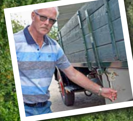
Anders visar lösningen för att lämmarna inte ska bukta ut. Med en spak släpps spänningen på järnet. Sedan blev kättingen vanlig.
