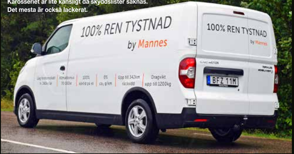
Den långa karossen bjuder på 6,3 m 3 lastutrymme och 269 cm lastlängd. Det innebär tre pallplatser bak i skåpet. Klätt är det också invändigt.
