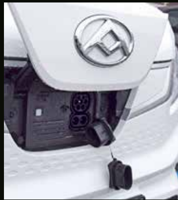
Fram i fronten där emblemet sitter är luckan för laddningsuttaget. På 6-8 timmar laddas batteriet. Med DC-laddning tar det 45 minuter.
