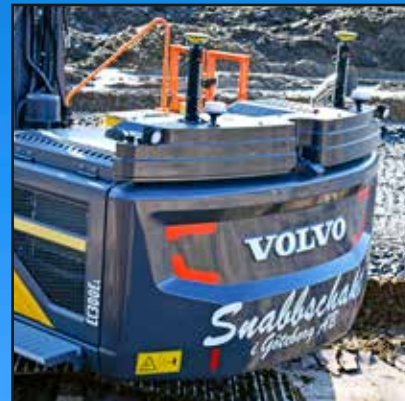
Extra motvikter sitter uppe på den befintliga motvikten. Extravikten väger två ton vilket är 500 kilo mer än vad som är brukligt på långgrävaren.
