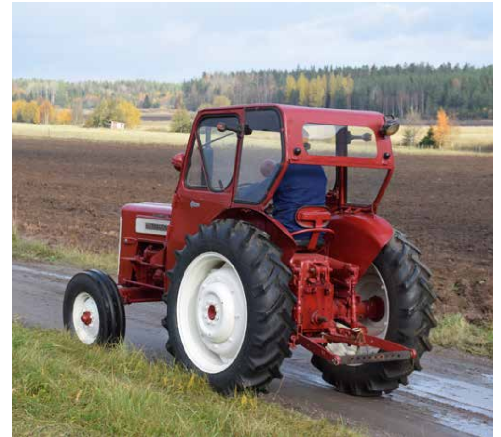
B-414 hade det "tänkande" hydraulsystemet med viktöverföring och djupkontroll. Luckan under bakrutan kom aldrig fram. Den tidigare ägaren ställde undan den.
