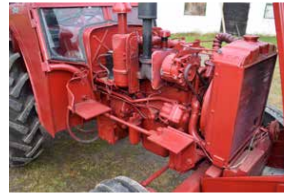
Motorn är BD-154, vilket innebär en 4-cylindrig vattenkyld 4-taktad förkammardiesel där 154 står för cylindervolymen i kubiktum. I liter var det 2,52.
