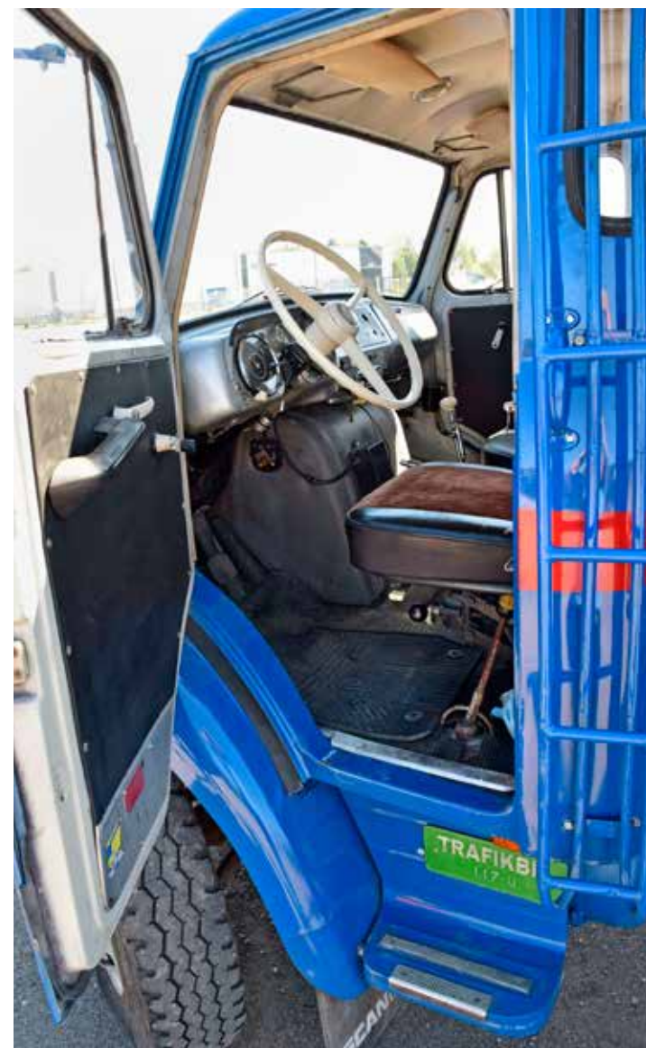
Utrymmet för pedaler och fötter är begränsat mellan hjulhus och motor-kåpa, med den halvt frambyggda lösningen.
