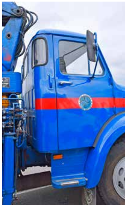
Hytten SV 1080 var banbrytande genom att huvparti, torped och hytt satt ihop i en enhet. Till efterföljaren L50 namnändrades hytten till HL11.
