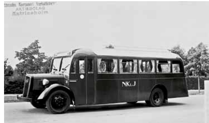
Nordmark-Klarälvens Järnväg hade Volvo B11:an från 1937 med Katrineholmskaross. Fronten påminner om lastbilarnas men det är ett rent busschassi med uppbockad ram över axlarna.
