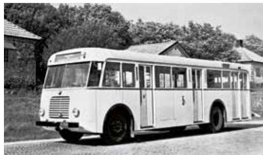
SKV i Katrineholm byggde denna stadsbuss för Malmö Stads Spårvägar på ett B533-chassie. Notera karossens tre dörrar varav de bakre dubbla vilket skulle underlätta av- och påstigning.
