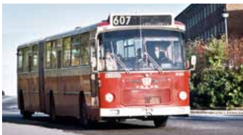
En av Stockholms Lokaltrafiks Volvo B58 ledbussar på linje 607 rullar i området Edsberg, Sollentuna 1971. Hög kapacitet och låga driftskostnader var något som talade för ledbussarna. Foto: Hans Liljewall.
