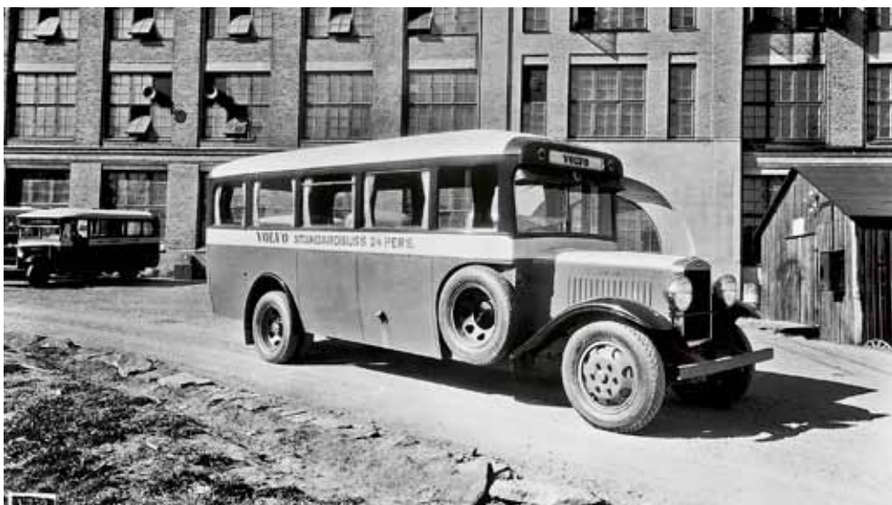
Demonstrationsbuss framför Volvofabriken på Hisingen. En standardbuss med kaross från Svenska Karosseriverkstäderna och plats för 24 personer på det omnibussanpassade chassit LV70B.
