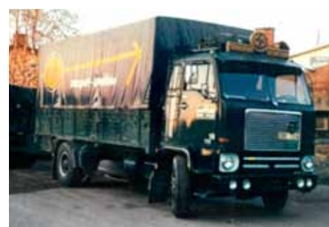
Tvåaxlig Volvo F88 med Forss sandaggregat.
