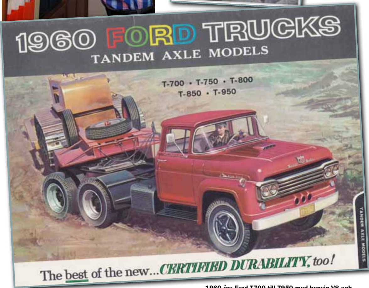
1960 års Ford T700 till T950 med bensin-V8 och tandemdriven boggi. Modellen förändrades en hel del i fronten till 1961 års modeller.
