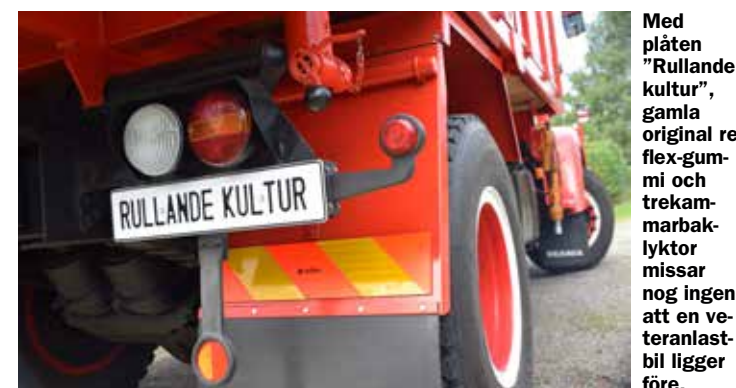
Trevägstippen från Zetterbergs kommer från donatorbilen men flaket har nästan byggts upp från grunden. Furu är träslaget.
