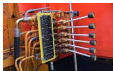
Idag styrs kranarna från en låda på magen. Men för inte så länge sedan var det spakning vid kranen som gällde.
