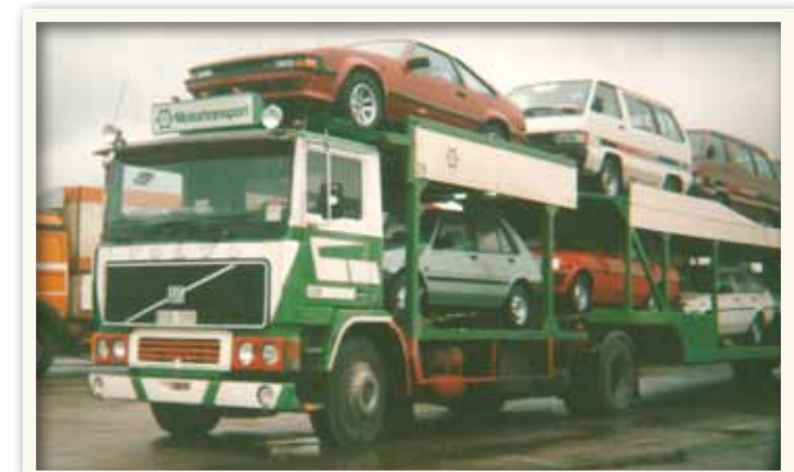
Volvo F10 biltransport. Ett bygge av ovanligare sort för Motortransport med plats två bilar på dragbilen, och resten av leveransen på trailern.
