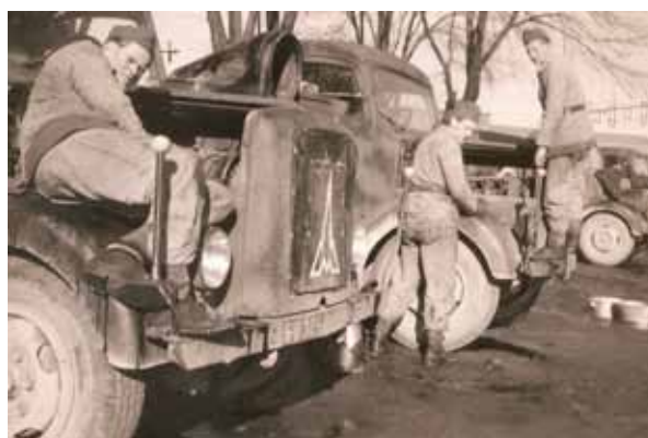
Torsten uppflugen på framskärmen för en översyn av den luftkylda Deutzmotorn. Bilen heter S3500 och årsmodellen är kring 1950.
