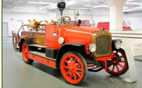
Magirus 2 CS , tillverkad 1920. Under huven satt en 55-hästars fyrcylindrig bensenmotor. Vattenkyld ska nämnas. Stegen kallades för Bayern.
