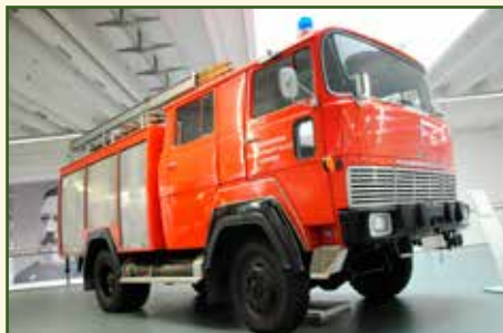
Samlingens enda frambygge. En 176-hästars Magirus 170 D 11 FA från 1970. Ett riktigt höghus med sin högt placerad dubbelhytt och allhjulsdraft.
