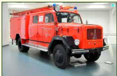
In på 1960-talet kantade designen till sig betydligt. Här en Mercur 150 D 10 A räddningsbil från 1965. Drift på båda axlarna avslöjar markfrigången och kardanklumpen på framaxeln.
