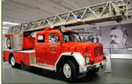
Här en Mercur 150 D 11 från 1970. Motorn bjöd på 150 hästar och stegen heter DL 30h.
