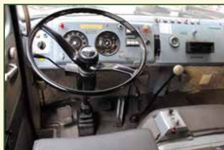
Förarmiljön från 70-talet känns avlägsen även om mycket känns igen. Mycket plåt och bakelit. Och ett spett i golvet som användes för att byta växlar med.
