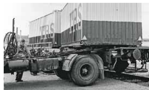
På järnvägs-vagnen var containern i framkant fastlåst med löstagbara låspinnar i järnvägs-vagnens låsmekanism och i bakkant i dubbar på ett slags glidskenor för att med hjälp av dragbilens wirevinsch snedställa containern på järnvägs-vagnen.
