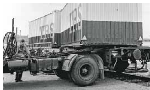
På järnvägsvagnen var containern i framkant fastlåst med löstagbara låspinnar i järnvägsvagnens låsmekanismer och i bakkant i dubbar på ett slags glidskenor för att med hjälp av dragbilens wirevinsch snedställa containern på järnvägsvagnen.
