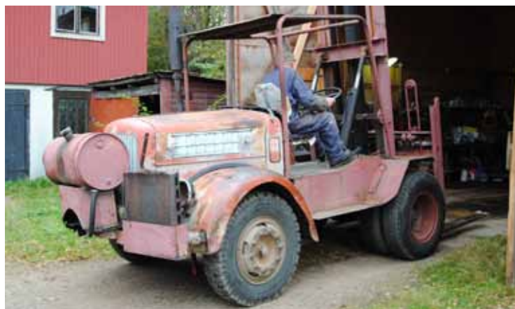
En Scania-Vabis L51 från 1956 använde sig Erling av för att bygga en brädgårdstruck till sin sågverksamhet.
