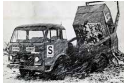
Stora Åkeriets lastbilar fick ofta slita hårt. Här deras Volvo F85 med liftdumper som tömmer containern på en tipp en snötung dag.
