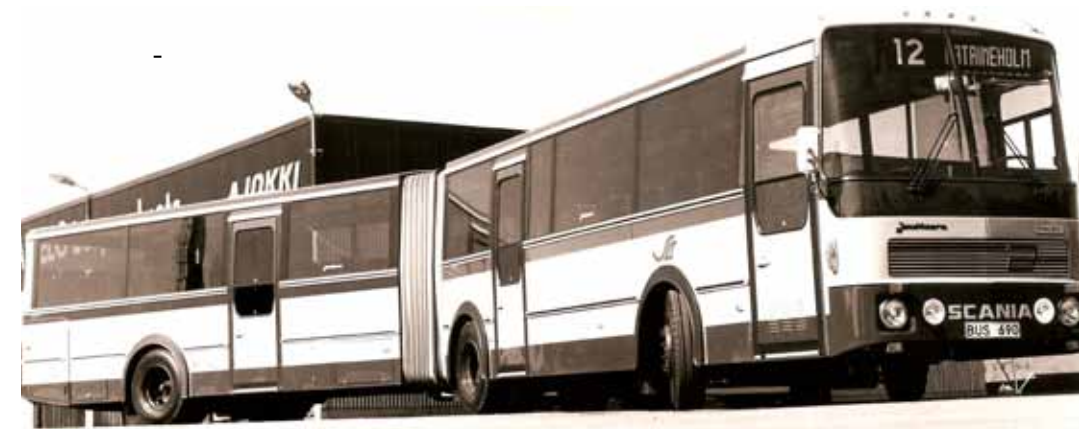
1979 visades denna BR112A ledbuss med kaross från belgiska Jonckheere för Södermanlands Läns Trafik AB. Bland annat utprovades ett automatiskt ledkontrollsystem på bussen.
