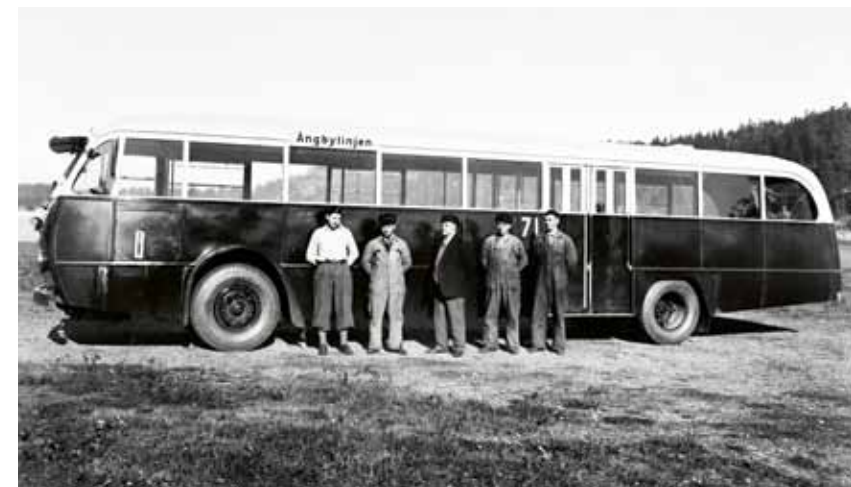
Stockholms Spårvägars bulldogbuss typ 8601, tillverkad från 1936 till 1938 med framflyttad förarplats, och där motorn satt helt framför framaxeln.
