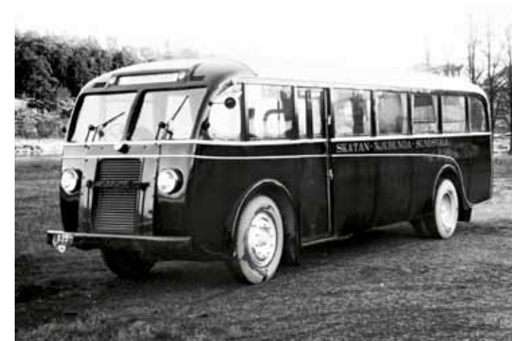
Året är 1936 och bulldoggbussen är av typ 8416 med den av Scania-Vabis nykonstruerade 120-hästars 16641-dieselmotorn.
