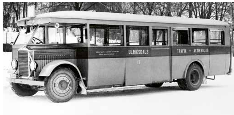
Ulriksdals Trafik Aktiebolag hade 1931 denna Scania-Vabis halvhvittsbuss typ 8501. Modellen, efter engelsk förebild, tillverkades från 1930 till 1935.
