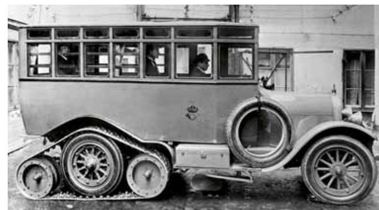
Samarbetet med Generalpoststyrelsen utmynnade 1922 i denna postdiligens Typ 3241, vars speciella drivning hade en fransk ökenbil som förebild.
