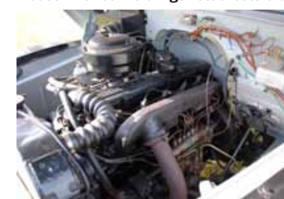
Den raka dieselsexan gav på den tiden tillräckliga 97 hk. Idag skämmer den inte för sig i det välskötta motorrummet.
