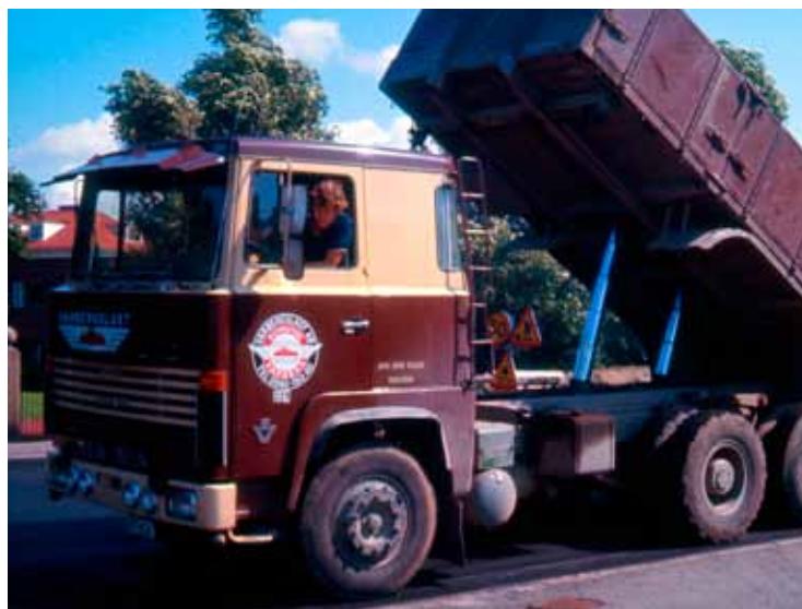
Leif Johansson från Källsjö lägger asfalt på Träslösvägen i Varberg 1972 med sin Scania LBS140 ansluten till Varbergslast. Foto: Lennart Hellin.
